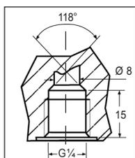
Линия всасывания ① и обратная линия ② с прямым монтажом шлангов для модификации 5 и 6 (также возможно применение кольцевого уплотнения)
